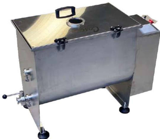
Современное устройство для быстрого и эффективного производства масла. Электродвигатель с регулируемой скоростью обеспечивает управление технологическим процессом и адаптивность к различному содержанию жира в продуктах (до 36%).
