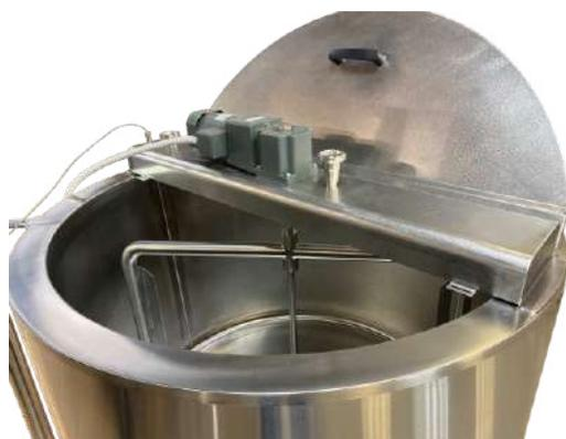
Предназначена для обеспечения эффективного нагрева продукта в сыроизготовителях и пастеризаторах от 500 литров рабочего объема.
